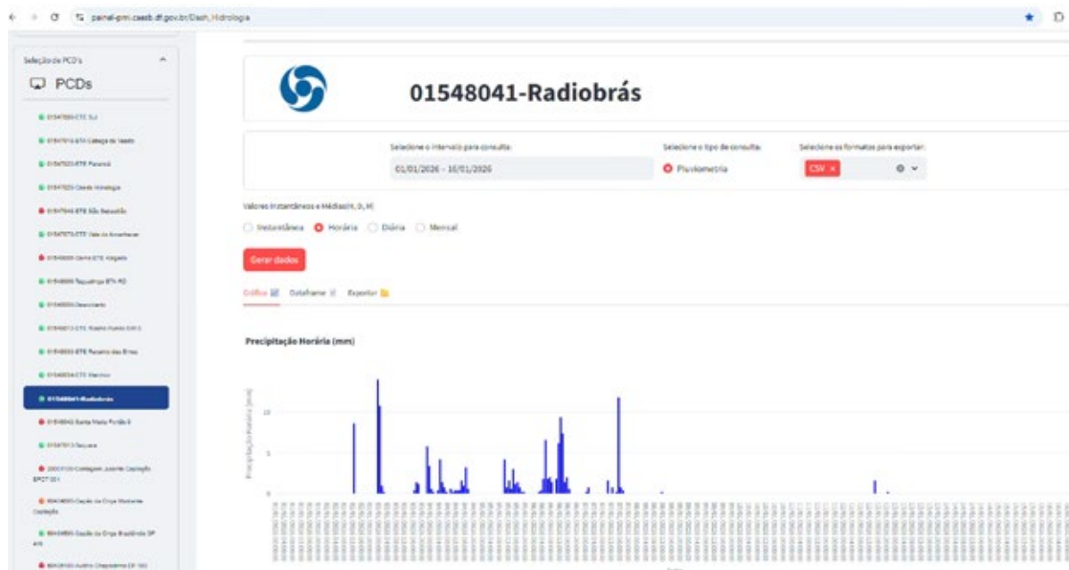
Figura 2 – Interface do Sistema PMIAA apresentando o total precipitado em uma estação pluviométrica, ao longo das horas, para um determinado período.
