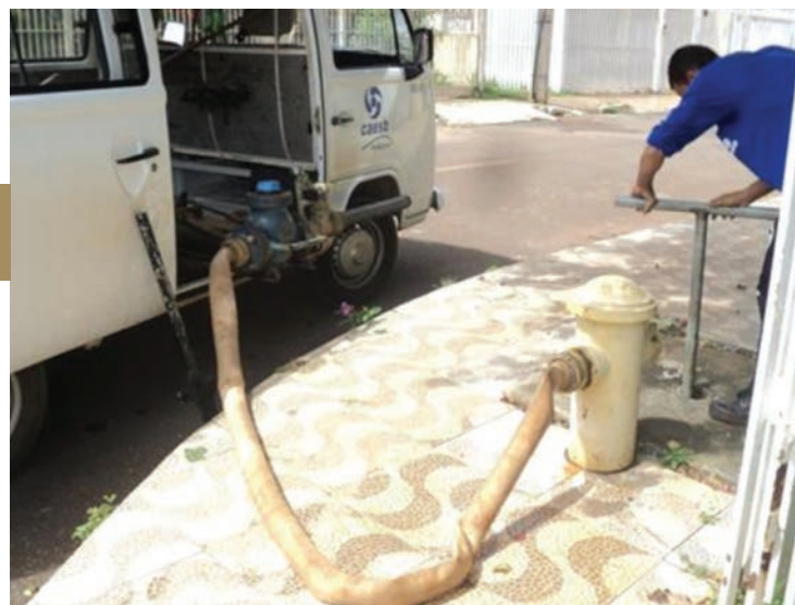
Figura 17 – Exemplo de medição de descarga em hidrante
